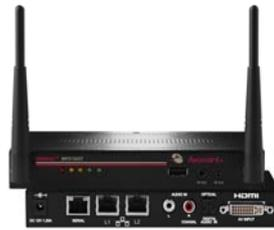
El sistema de envío de video en alta definición se compone de dos elementos claves: un escalador HDMI (que nos permitirá convertir la señal de video a formato de alta definición) y un emisor wireless que nos permite llevar la señal escalada al destino donde deseemos.
